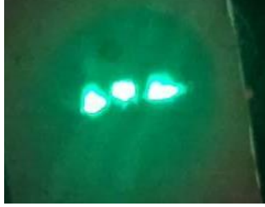
Fig. 2 過 BBO 有產生 autocorrelation 的光斑
