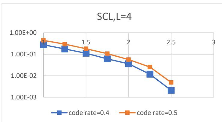
不同編碼率的性能比較，從圖中可以看出，對於編碼率較小的解碼，其錯誤率也相對較低，因為編碼率的公式為資訊位元除以所有位元，所以編碼率小也代表在通道極化後，可以選擇容量較接近1的通道，極化較完全的通道，如圖三所示，而中間那些因為碼長有限而通道極化不完全的位元，會優先被排除掉，所以解碼錯誤率自然會降低。
