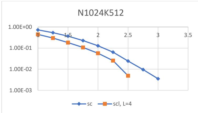
SC解碼及SCL解碼的性能比較，從圖中可以看出，相較於SC解碼，SCL解碼更具有更低的錯誤率，隨著L的增加，SCL的效能也會有顯著的增加。
